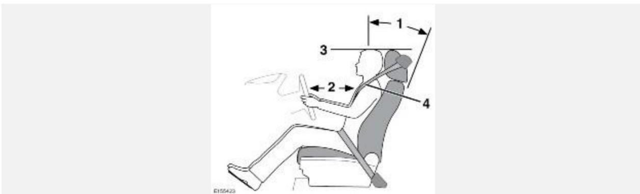
1. Сядьте прямо. При этом поясница должна плотно прилегать к спинке сиденья. Чтобы обеспечить оптимальную защиту с помощью ремня безопасности в случае ДТП, не наклоняйте спинку сиденья слишком сильно назад.
