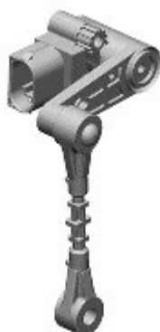
Рис.15. Датчик высоты адаптивной подвески Discovery Sport
